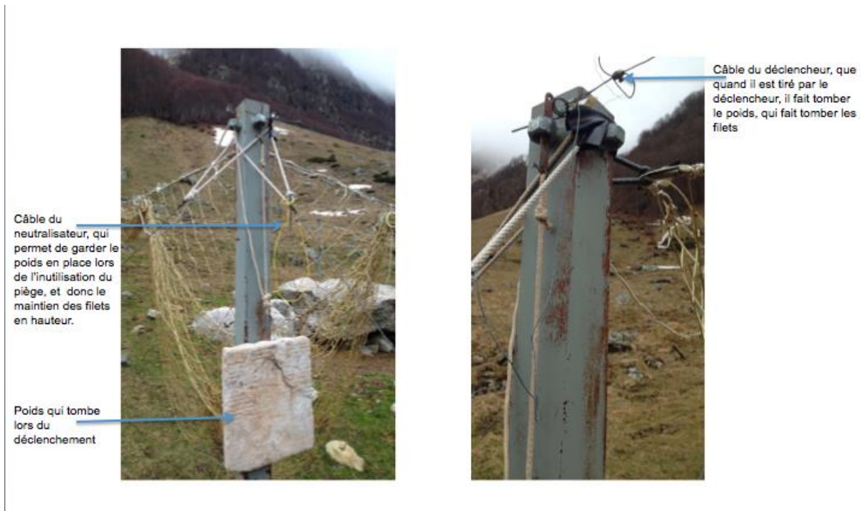
Figure 14. Fonctionnement du poids et de la goupille
