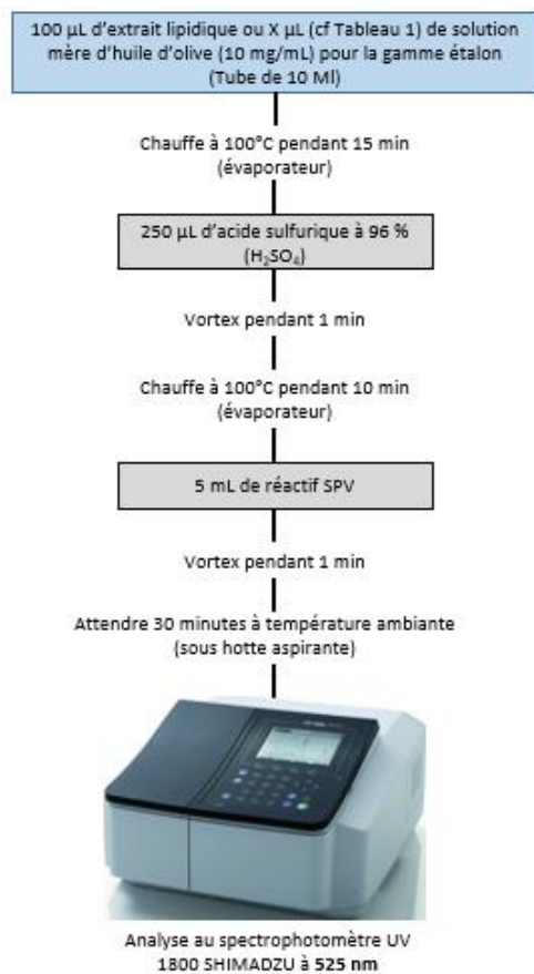
Figure 1. Schéma du protocole pour l'extraction et l'analyse des lipides.
