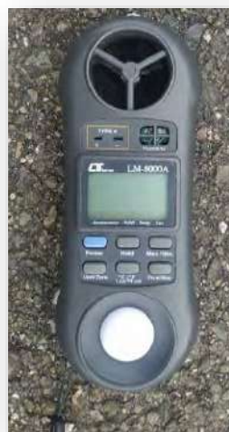
Figure 8 : Capteur météo Lutron « LM-8000A » Source : Photo personnelle
