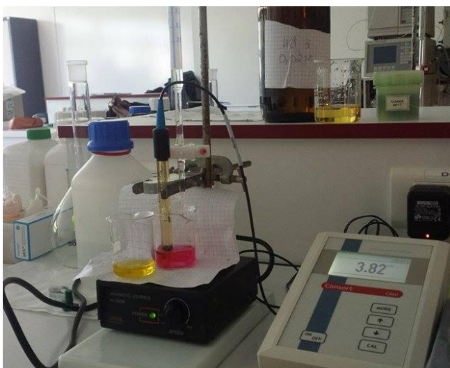
Figure 32 : Photo du montage expérimental utilisé lors de la titration des échantillons.
