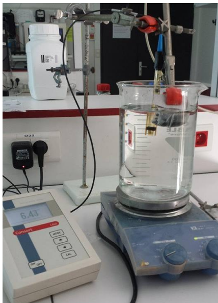
Figure 30 : Photo du montage réalisé lors du lavage des charbons.
