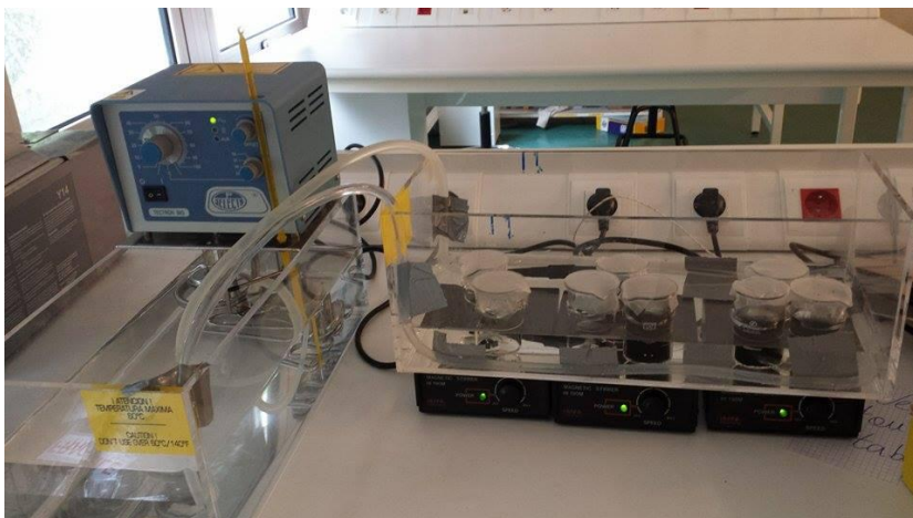
Figure 31 : Photo du montage réalisé (système de circulation) afin d'agiter les échantillons tout en les maintenant à une température de 25°C.
