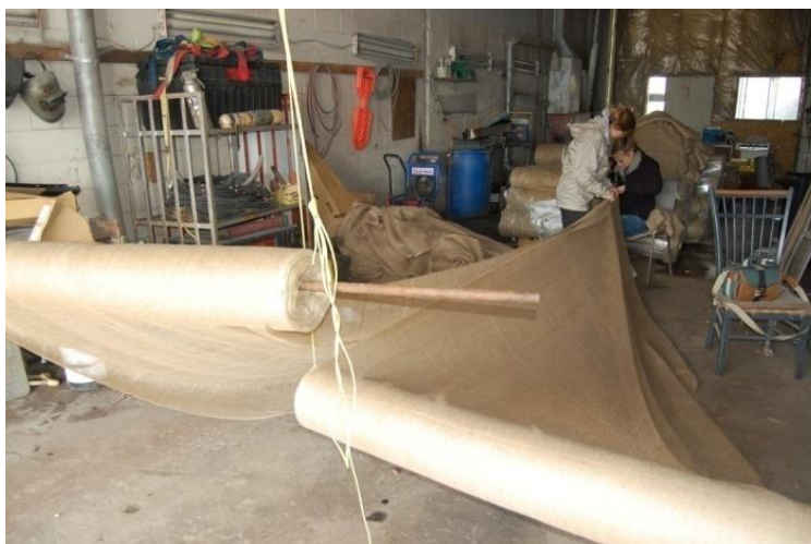
Figure 8 : Deux rouleaux de toile de jute sont cousus ensemble sur la longueur (Source : ABV des 7)
