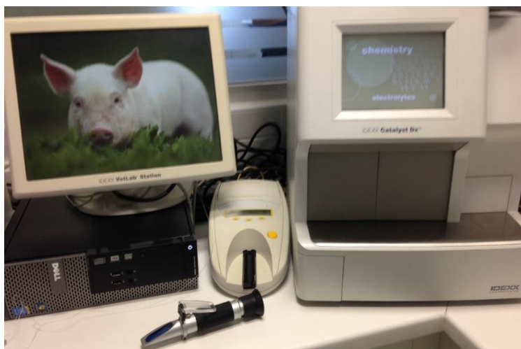
10. De gauche à droite : la station VetLab qui permet de lancer toutes les analyses ; le réfractomètre portable ; le lecteur de bandelette urinaire VetLab UA et l'analyseur de biochimie Catalyst Dx.
