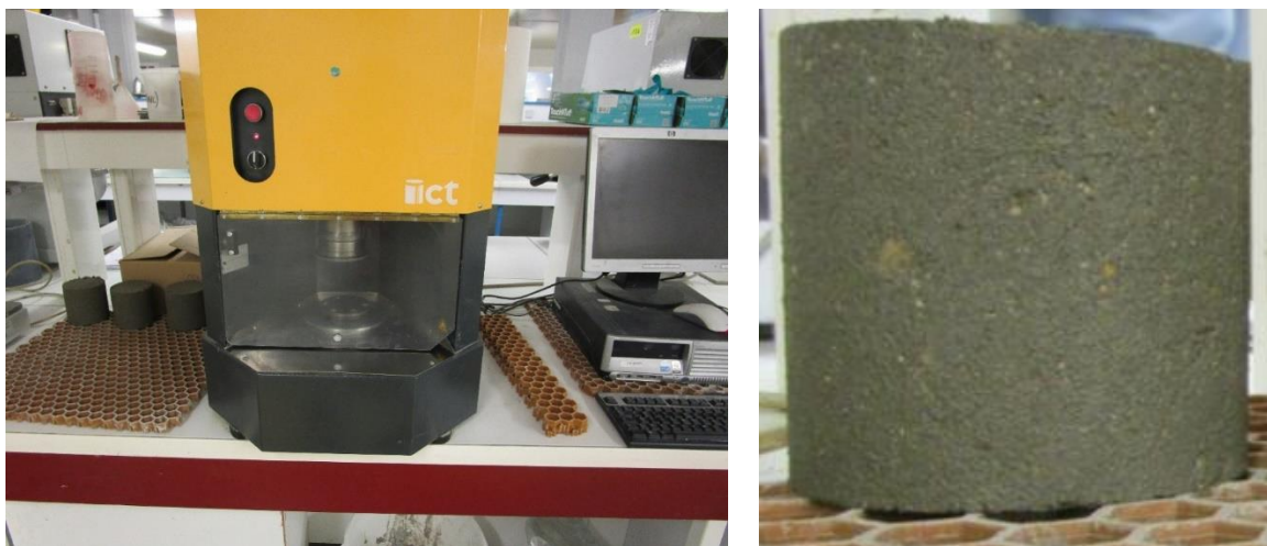
Figure 11 : Gyrocompacteur (gauche) et éprouvette de béton obtenue après compactage dans le gyrocompacteur (droite)
