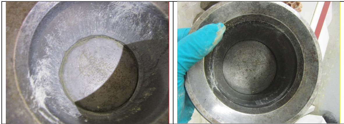
Figure 17 : Avec à gauche le moule après compaction du béton sans adjuvant et à droite le moule après compaction du béton avec 0,3% d'agent de compaction de référence.
