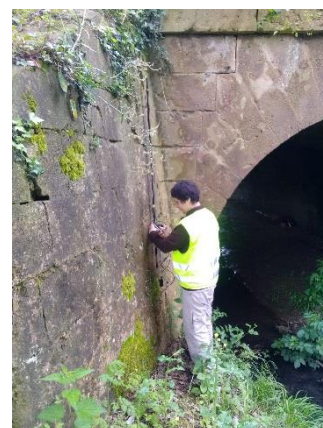
Figure 4. Prospections d'une cavité à l'aide d'un endoscope couplé à une perche télescopique (CAPITANIO, 2018)
