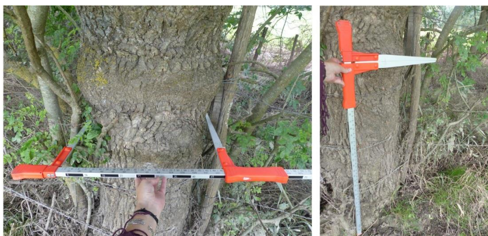
Figure 9 : Utilisation du compas forestier pour la mesure du diamètre et de la hauteur (Source : Nolwenn VIVERET)
