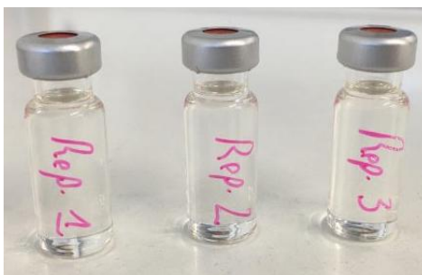
Figure 19 : Trois échantillons du mélange ternaire équimolaire préparés dans des vials à sertir pour vérifier la validité de la calibration
