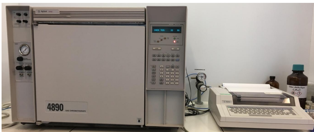
Figure 6: Façade avant du Chromatographe 4890 D de chez Agilent et de son intégrateur tous deux placés sous une sorbonne dans le laboratoire
