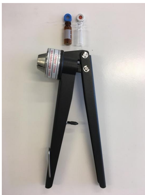
Figure 8: Vial avec son bouchon à visser (en haut à gauche), vial avec son bouchon à sertir (en haut à droite) et pince permettant de sertir
