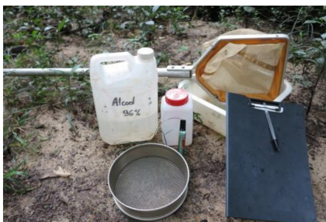
Figure 6 : matériel de prélèvement au filet Troubleau (tamis de maille 2mm, fiches terrain, marqueur, récipient hermétique, alcool à 96%, bassine, filet Troubleau) © Hydreco
