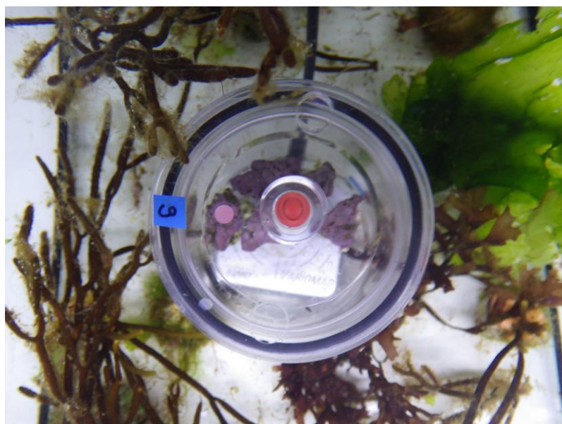
Figure 28 : Photo de la pastille rose au-dessus du numéro de couvercle servant à mesurer le dioxygène dissout avec une fibre optique
