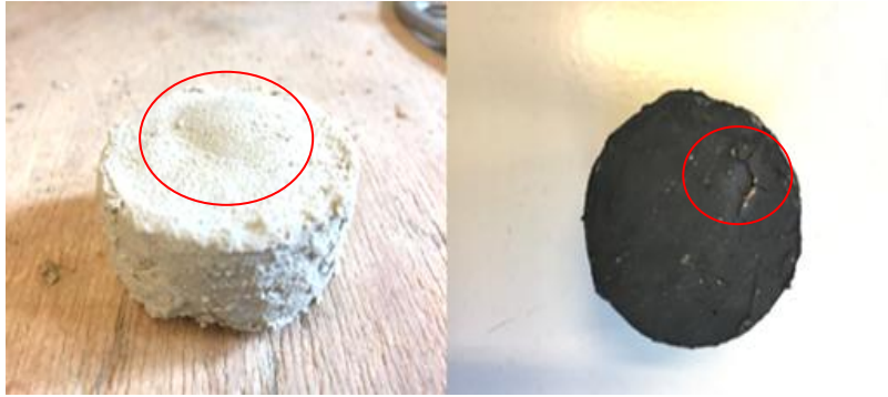
Figure 16. Echantillon colle cloqué (à gauche) et échantillon mastic fissuré (à droite) à 200°C
