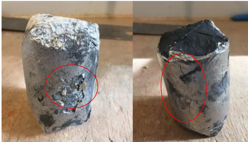
Figure 18. Echantillon colle+alu (à gauche) et mastic+alu (à droite) fissurés à 600°C
