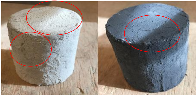
Figure 17. Echantillon colle cloqué et fissuré (à gauche) et échantillon mastic fissuré (à droite) à 600°C
