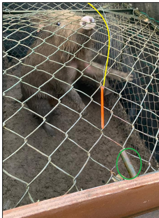
Figure 20: Photo montrant le clou (en orange) sortie de son encoche (entourée en vert) après ouverture de la tapette à oiseau et qui maintenait la porte coulissante (en marron). Comme sur la figure précédente, le fil jaune représente la liaison du clou avec le piège à oiseau.
