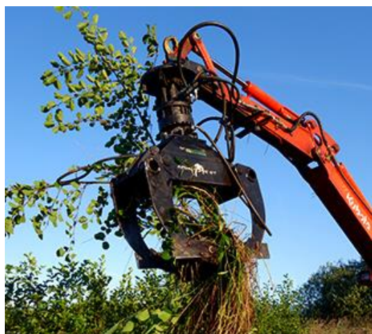
Figure 21 Arrachage à l'aide d'une rétropelle munie d'une pince spéciale (Source : https://grande-caricaie.ch/fr/travaux-d'entretien/travaux-dans-les-marais/ )
