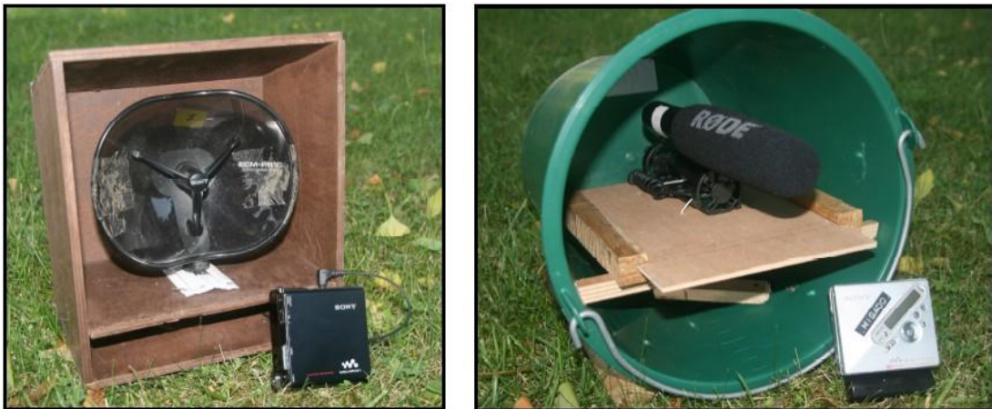
Figure 11 : Dispositif d'enregistrement avec micro parabolique et enregistreur SONY MZ-RH1 (à gauche) et micro directionnel avec enregistreur SONY MZ-N710 (à droite)
