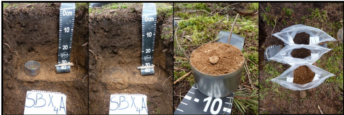
Figure 10: Densité apparente grâce à la méthode des cylindres
