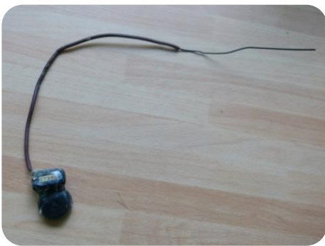
Figure 15 : Photo d'un radio-émetteur VHF.
