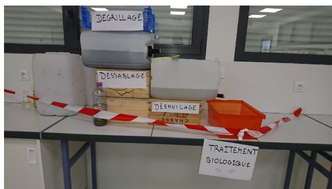
Figure 6 - Maquette d'une Station d'épuration
