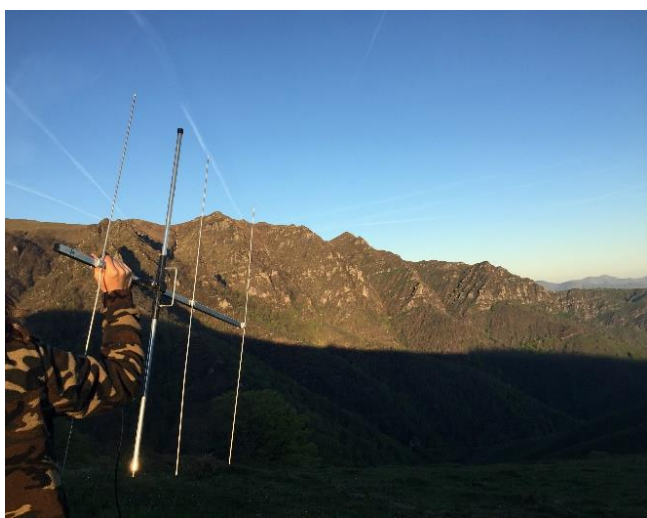
Figure 21. Utilisation de l'antenne à radiofréquence pour détecter la présence d'Isards portant des colliers émetteurs
