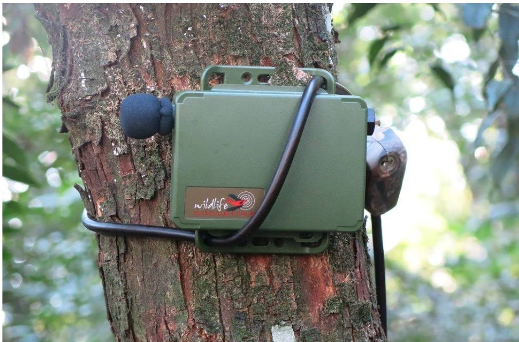
Figure 5 : Enregistreur SM Mini opérationnel (Gravador Song Meter Mini)
