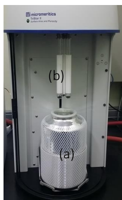
Figure 43. Photo du TriStar II avant étalonnage et analyse, (a) Dewar, (b) manchon de contrôle de température
