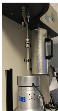
Figure 38. Photo du montage pour l'analyse à l'autosorb iQ, (a) cellule d'échantillonnage, (b) Dewar, (c) écrou
