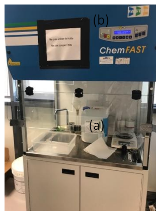
Figure 48. Photo de la hôte dédiée au analyse mercure disponible en laboratoire, (a) bidon déchet mercure, (b) activation de la hôte
