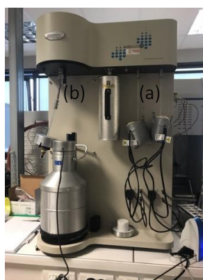
Figure 33. Photo autosorb iQ disponible en laboratoire, (a) station de dégazage, (b) station d'analyse.
