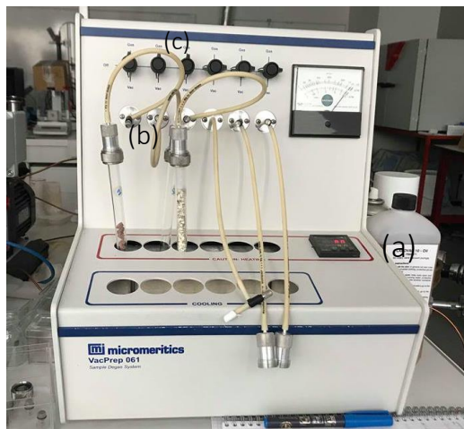
Figure 40. Photo du VacPrep 061 disponible en laboratoire, (a) contrôle de température, (b) tuyau d'échantillonnage, (c) valve d'activation du vide.
