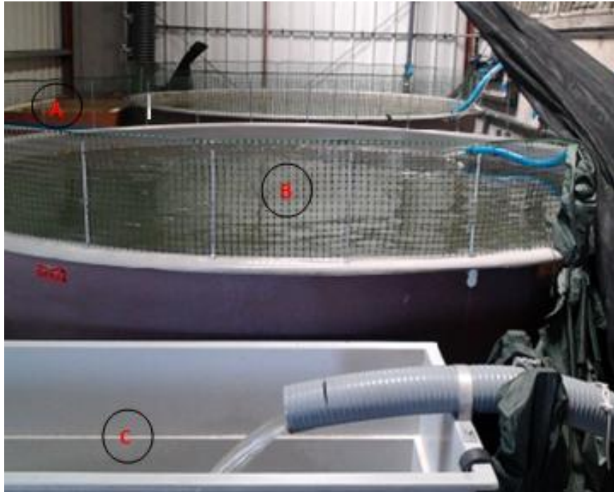
Figure 8 A : Cuve de reprise. B : Bassins géniteurs. C : Bac de récolte des œufs Source : A.Girard
