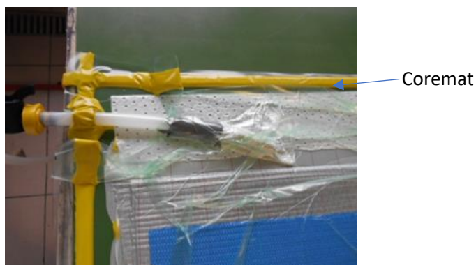
Figure 8 : vide parallèle sur Coremat
