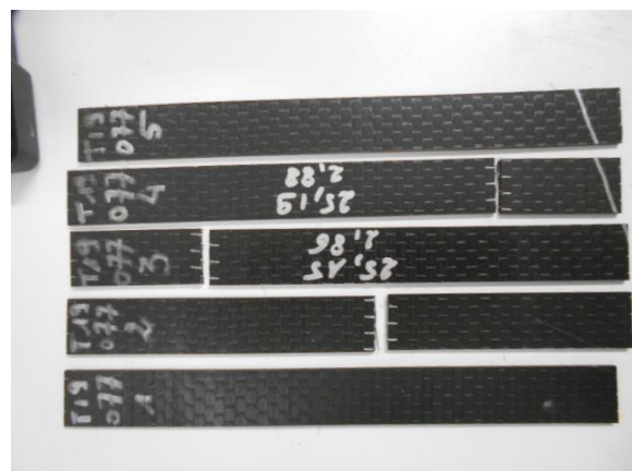
Figure 16 : Ruptures situées à hauteurs différentes
