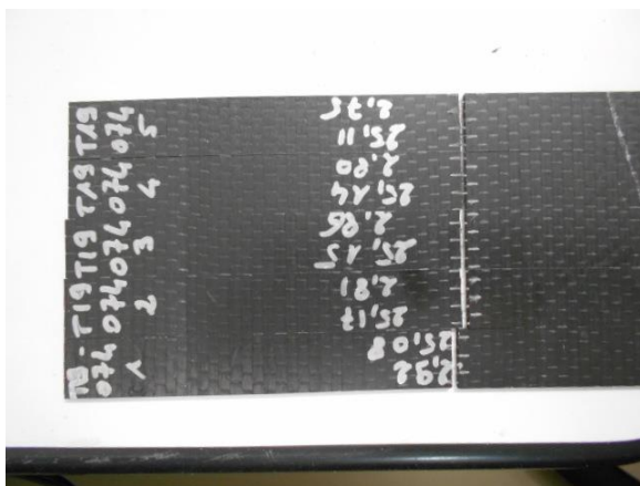
Figure 15 : Ruptures situées à la même hauteur
