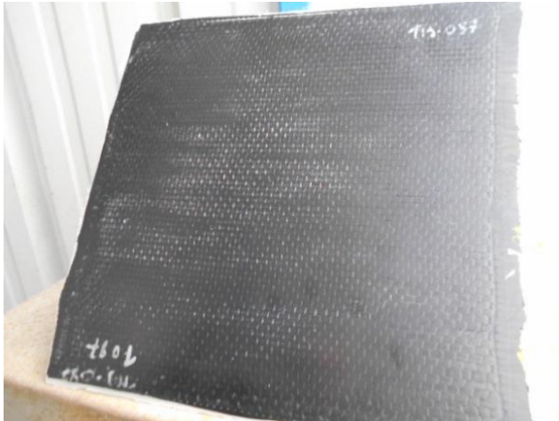
Figure 11 : plaque sans additifs sur moule composite avec vide parallèle sur Coremat et une pression à – 900mbar
