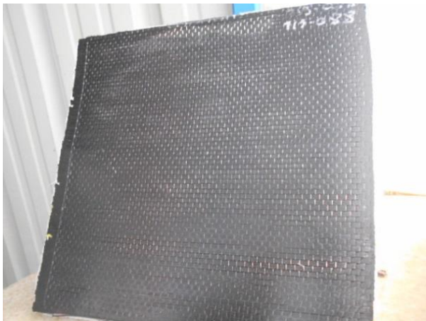
Figure 12 : plaque sans additif sur moule composite avec vide perpendiculaire et une pression de -500mbar
