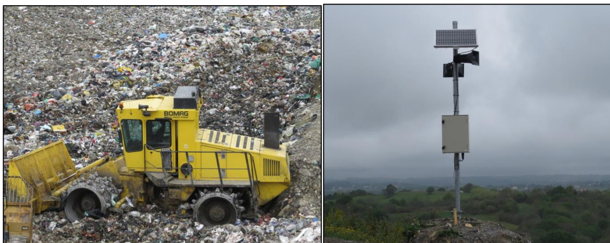
Figure 9 : Matériel d'effarouchement (à gauche : effaroucheur mobiles sur compacteur, à droite : effaroucheur fixe)
