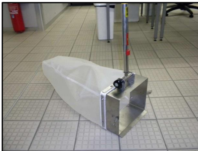
Figure 8 : Haveneau de prélèvement en hautes eaux ( http://www.auvergne.developpement-durable.gouv.fr )
