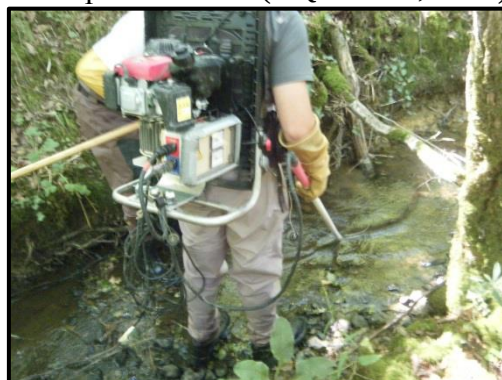
Figure 13 : Groupe électrogène relié à l'anode
