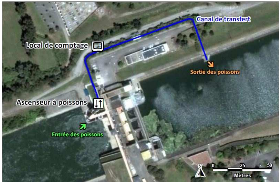
Figure 12 : Schéma de principe de l'ascenseur à poissons du barrage hydroélectrique de Golfech
