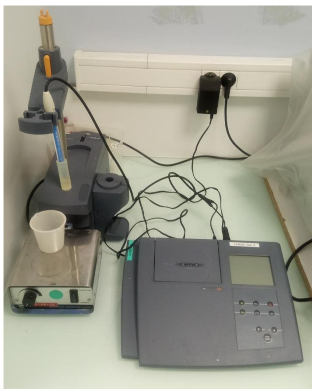
Figure 6 pHmètre utilisé pour les mesures par potentiométrie
