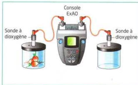
a. Dispositif ExAO permettant de mesurer, grâce à une sonde, la quantité de dioxygène dans l'air d'une enceinte (en présence ou en absence de végétaux).
