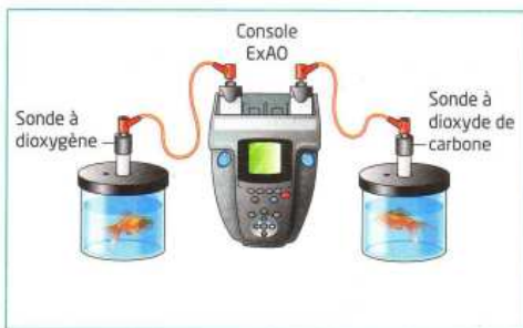
c. Dispositif ExAO permettant de mesurer, grâce à des sondes, les quantités de dioxygène et de dioxyde de carbone dissoutes dans l'eau d'une enceinte contenant un poisson.
