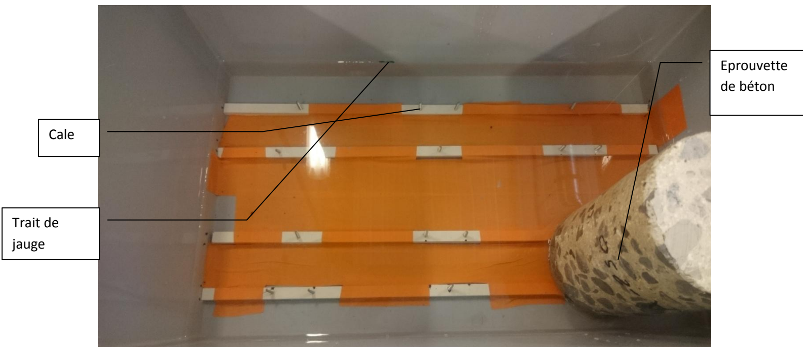
Image 6 : montage expérimental pour l'essai d'absorption capillaire
