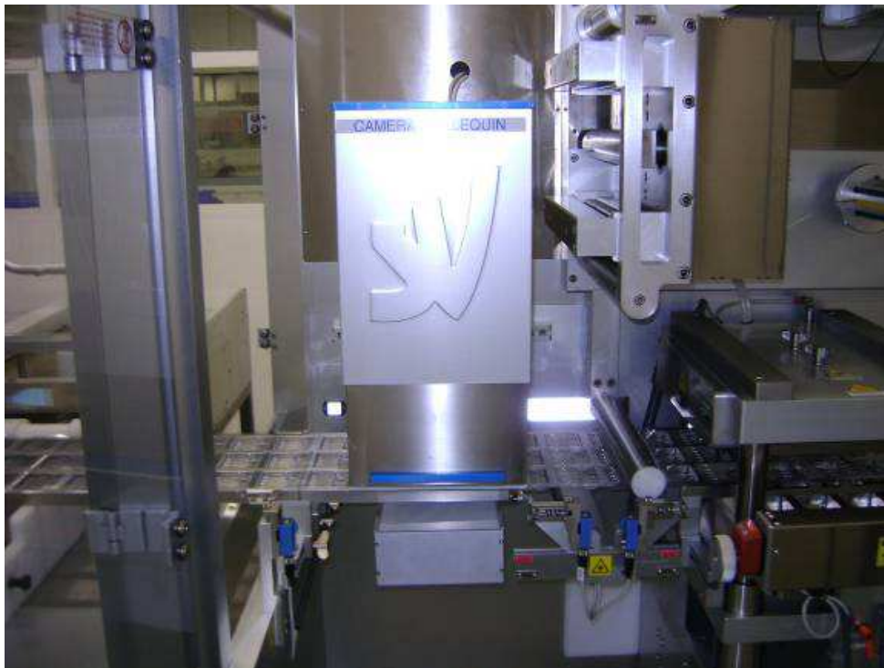
Figure 3: Le système de vision des thermoformeuses
