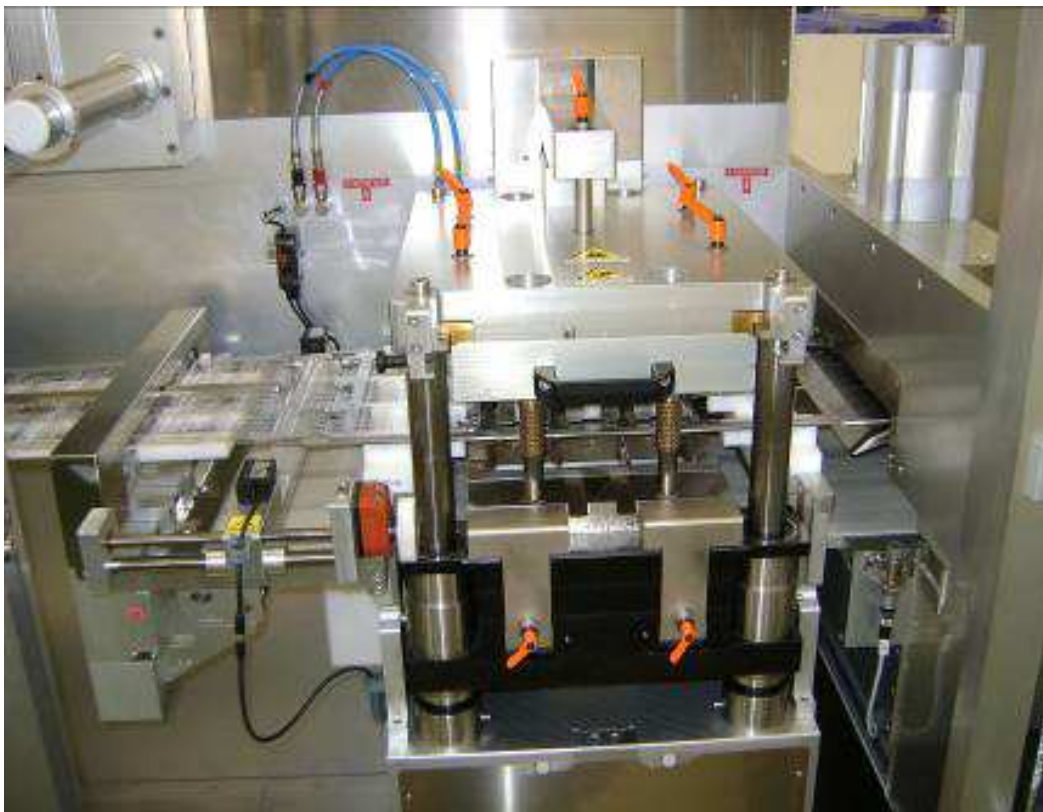
Figure 5: Le système de découpe des barquettes
