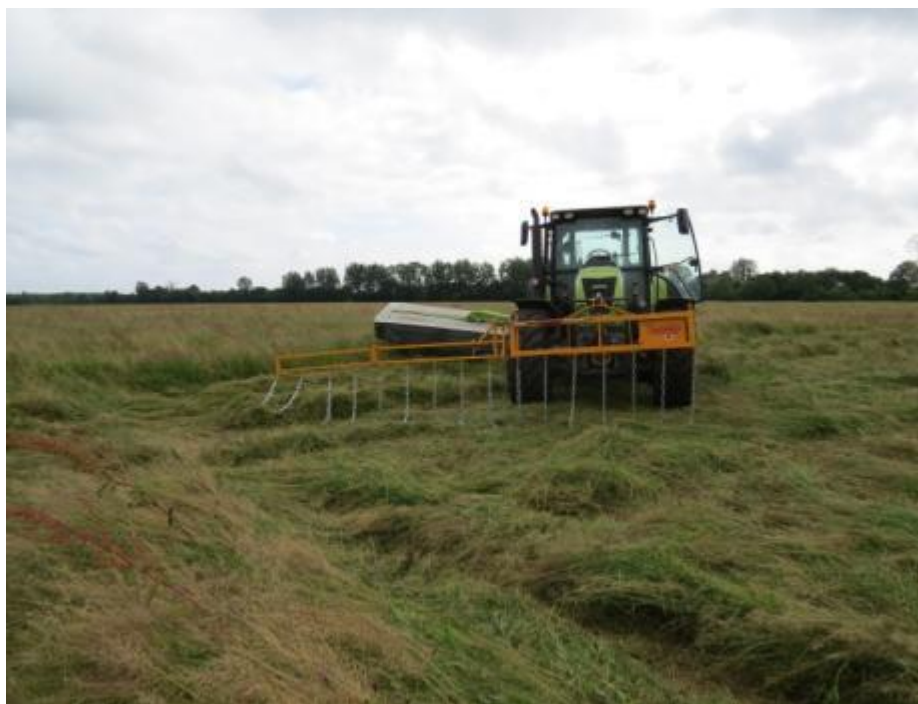
Barre d'effarouchement avec un système d'attache unique sur la barre de masse ©A. Artaux, CA49
