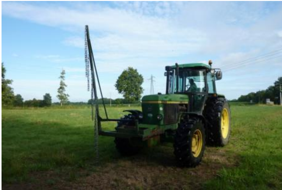
Barre d'effarouchement avec un système d'attache unique sur la barre de masse ©A. Artaux, CA49
