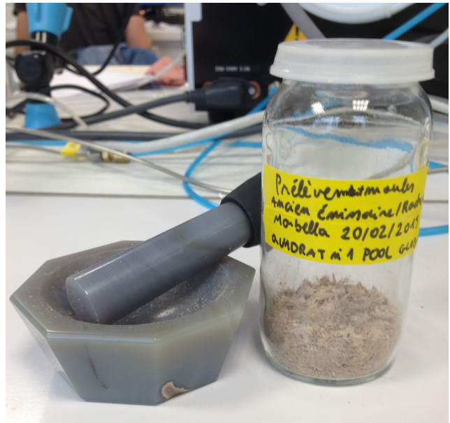
Figure 20. Constitution des pools avec les moules lyophilisées broyées à l'aide d'un mortier en agate
