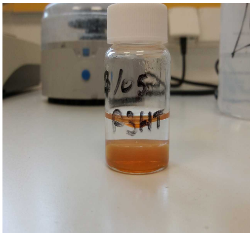
Document 8: Pilulier contenant la silice et le P3HT: on voit bien les deux phases superposées (l'eau est en haut car elle est moins dense que le chloroforme)
