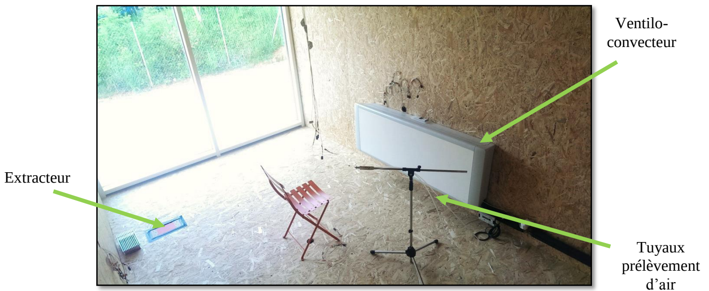
Photo n°4 : Configuration de la cellule
