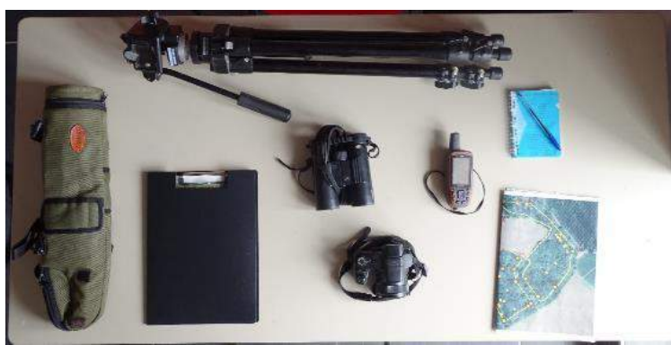
Figure 10 : Matériel utilisé pour la phase de terrain. (De gauche à droite, de haut en bas) : longue vue matériel Kite Forster, grossissement X10), fiche de relevé, appareil photo numérique (matériel Sony DSC-HX200), GPS garmin 64s, carnet de note, crayon.
