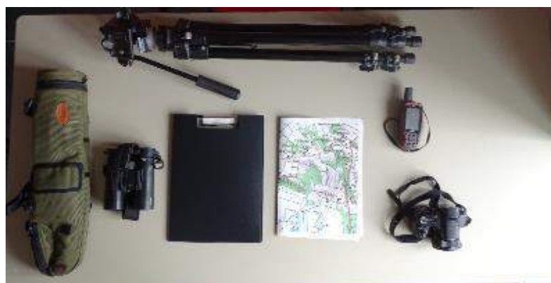
Figure 11: Matériel utilisé pour la phase de terrain. (De gauche à droite, de haut en bas) : une longue-vue (matériel KOWA, grossissement X32), jumelle (matériel Kite Forster, grossissement X10, fiches de relevé, les cartographies du site d'étude, un GPS garmin 64s, un appareil photo numérique (matériel Sony DSC-HX200).
