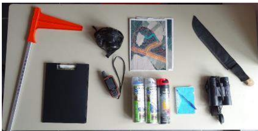
Figure 6 : Matériel utilisé pour la phase de terrain. (De gauche à droite, de haut en bas) Pied à coulisse forestier (mesure maximum : 50cm), fiche de relevé, appareil photo numérique (matériel Sony DSC-HX 200), Gps Garmin 64s, cartographie des parcelles, bombes forestières de couleur (bleu, rouge et blanche), machette, carnet de note, crayon, jumelles (matériel Kite Forster, grossissement X10).
