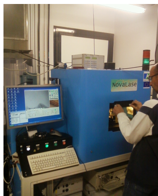
Figure 8 : Laser destiné à l'ablation sur l'otolithe
